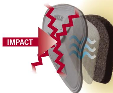
Protection optimale à l'aide de trois couches qui dévient, absorbent et amortissent les pressions et les chocs exercés sur la cheville. Le système de protection de la cheville MASCOT est certifié EN ISO 20345 et assure une protection quatre fois supérieure aux exigences de la norme. Innovant, il permet de réduire les impacts de choc à 4,8 kN.
